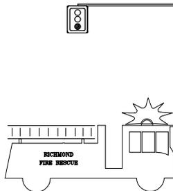
TRAFFIC CONTROLLER OUTPUTS SPECIFIED LIGHT SEQUENCE PRIOR TO EMERGENCY VEHICLE ARRIVAL
